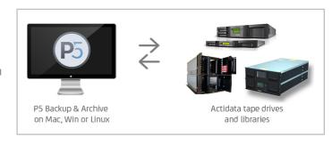
Für LTO-Bänder bietet die Parallelisierungsfunktion Skalierbarkeit hinsichtlich der Leistung. Mehrere Laufwerke erweitern die Anzahl der gleichzeitig laufenden Sicherungs-/ Archivierungs-/Wiederherstellungsaufträge.
